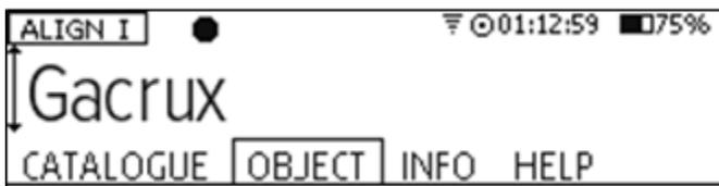
Gacrux a été sélectionné car il est bien au-dessus de 30 degrés. Maintenant, le télescope doit être pointé vers Gacrux en utilisant un oculaire avec réticule ou un oculaire à très fort grossissement. Appuyez sur la touche OK une fois que le télescope pointe vers l'étoile.
