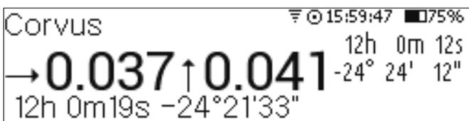
Nexus DSC montre la position actuelle du télescope au bas de l'écran et sur la droite est la coordonnée de l'objet transformé à l'époque actuelle. Le coin supérieur gauche montre la constellation où le télescope est actuellement pointé.
