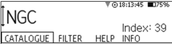
Il y a quatre onglets en bas de l'écran : **CATALOGUE**, **FILTER** (FILTRE), **HELP** (AIDE) et **INFO**. Un onglet est sélectionnable en appuyant sur les touches ◀ et ▶
