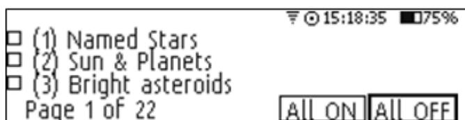
Utilisez les touches ◀ et ▶ pour naviguer entre les catalogues pour sélectionner / désélectionner et aussi pour accéder aux boutons **All ON** et **All OFF** boutons.
