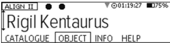
Veuillez suivre la procédure décrite ci-dessus pour modifier la sélection du deuxième objet d'alignement si nécessaire. Appuyez sur la touche OK une fois l'étoile au centre de l'oculaire.
