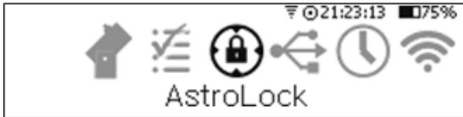
AstroLock™ permet de suivre les objets lorsque le contrôleur de moteur utilisé n'a pas les rapports de vitesse configurés avec précision. Lorsque AstroLock est activé le Nexus DSC détecte quand le télescope commence le suivi et se verrouille sur cette coordonnée et ajuste les vitesses de déplacement pour garder le suivi du télescope verrouillé sur cette coordonnée. Une autre option consiste à compenser un jeu lors du pivotement du télescope sur un objet dont la direction de suivi sera modifiée.
