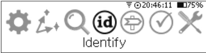
Dans le mode **Identifier**, vous pouvez sélectionner des catalogues d'objets à partir duquel Nexus DSC tentera de trouver l'objet le plus proche de la coordonnée actuelle du télescope. Le type d'Object, limitation de la magnitude et rayon de recherche peuvent également être spécifiés.
