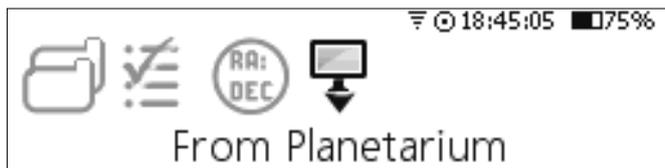
Nexus DSC montre la position actuelle du télescope au bas de l'écran et sur la droite est la coordonnée de l'objet qui a été reçu du logiciel planétarium. Le coin supérieur gauche montre la constellation où le télescope est actuellement pointé.
