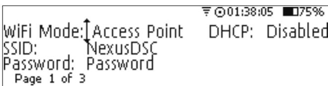
Si des paramètres par défaut doivent être utilisés, après avoir changé Mode WiFi à Point d'accès appuyez simplement sur OK
