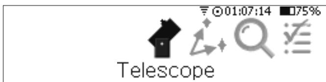
Nexus DSC prend en charge jusqu'à 5 configurations de télescopes différentes. Chaque configuration de télescope a son propre type de monture, Pas d'encodeur, valeur d'angle de référence d'altitude.
