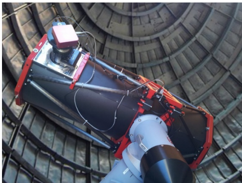
T lescope SkyVision 400 sous coupole en pilotage autonome
